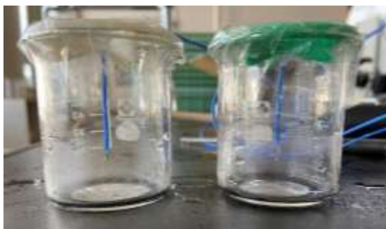
図1;自作した器具で熱電対温度計を固定したビーカー
