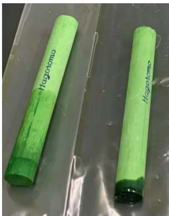
図 14(左が水を含んだチョーク、右が油を含んだチョーク)
