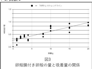
図2より、卵殻膜の量と ABS の減少量の間には明確な正の相関関係があるが、各データのばらつきが大きかったため、卵殻膜量と吸着量の具体的な関係は分からなかった。卵殻膜を10 g以上使用した実験系では、実験終了時の溶液の吸光度は開始時のものの 1/2 未満の物が観察された。卵殻膜を投入する前の初期値は、0 g として扱った。
