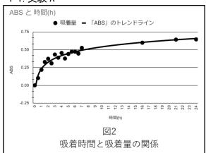
吸光度は、ピーク値(波長 515.0 nm~516.5 nm の範囲内)の値である。図1の縦軸は吸着前の溶液の濃度から各吸着時間の溶液の濃度を引いた値であり、実験開始時からの吸光度の減少幅を示している。すなわち、卵殻膜によるインク分子の吸着量を示している。時間経過とともに吸着量は増加した。しかし、実験終了時の溶液の吸光度は実験開始時の吸光度の1/2 より大きかった。なお、グラフ中にプロットされている値は、各時間における実験後の吸光度の値の平均値をとったものである。また、0時間のときの吸光度は実験開始時の溶液の吸光度である。
