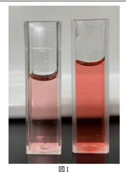
吸着前の溶液(左)と吸着後の溶液(右)
