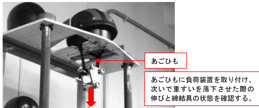
写真 2. 保持装置の強さ試験の様子
