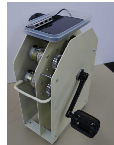
完成した充電機
