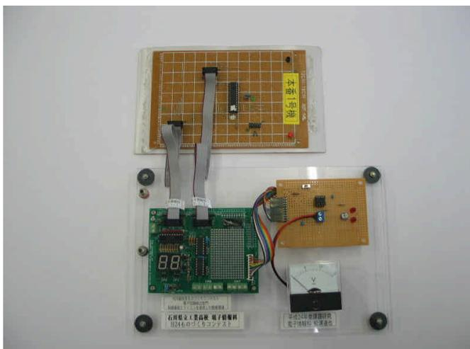
上の大きい回路はマイコン用の基板で、PIC マイコンを乗せます。
