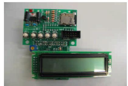
図2 液晶・microSD基板
