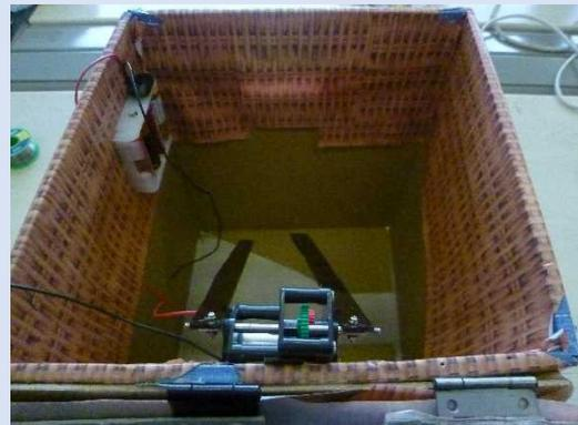
蓋に手をかざすと光センサが反応してモータを動かし、蓋が開いた。
