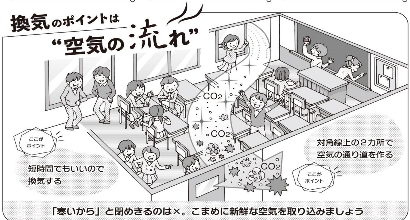
教室にあるCO<sub>2</sub>モニターでチェックして、1000ppmを超えたら、窓を大きく開けて風を通しましょう。
