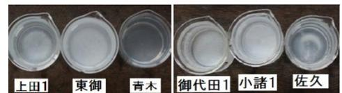
堆積岩層地区<sup>2)</sup>となり表流水を中心に原水としている。水質検査には、ケイ酸分析は求められず記載はない。だが、東御一小諸一御代田地域に居住する我々の生活感から、洗面所や風呂場の上水由来の石(ウロコ)は共通して認められておりケイ酸が絡んでいるものと考えられる。一方、青木村上水は蒸発残留物の質量は極めて小さい。表流水が中心であり雨水が沢に流れ込んでの受水となる。雨水の多くは山林の表土腐葉土層を通り抜け浄化された軟水が中心となっていると考えられる。
