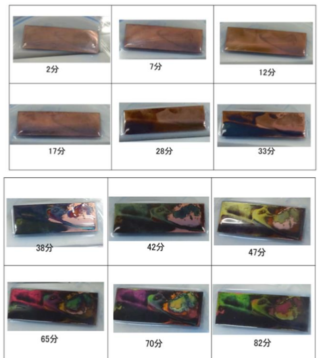
図6 実験IIの結果: 時間とともに色合いが変化する亜鉛板表面
