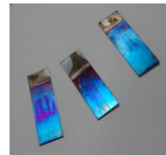
図3 55°C 2分でメッキされた亜鉛板
