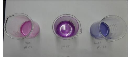
pH: 3.4 HCl添加    pH: 5.5 原液    pH: 6.3 NaOH添加
