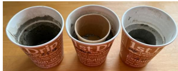
図6. バナナコンクリートプランターの製造
