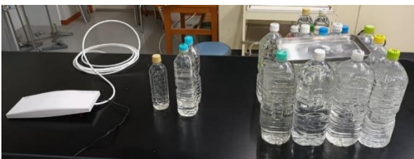
図1 実験1の様子。スマートフォン (右) の周りを水入りペットボトルで囲み、ルーター (左) からの電波のみをとらえるようにした。
