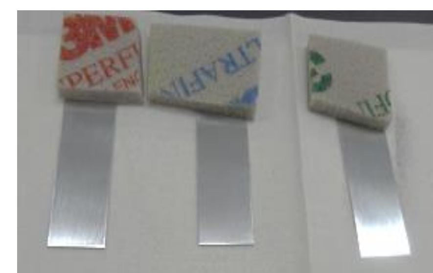
亜鉛板の研磨は3種の研磨ヤスリを使用して磨いた
