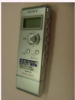
音声でメモ・記録などを取ります。手のひらサイズで持ち運びがしやすく、電源・録音・再生とも操作キーは小さいのですが、操作は簡単です。日付と時刻でデーターを管理することができます。学習場面では、観察・記録・インタビュー等で使用しています。
