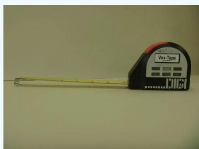
「VOXテープ」計測結果を音声で読み上げるステンレス製の巻き込み式メジャーです。1mmから5mまでを、一度に計測することができます。メモリー機能があり、計測した数値を保存し、加算して計測することもできます。「4メートル32センチ1ミリ」のように読み上げます。
