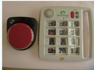
V O C A (Voice Output Communication Aid) とは、音声出力型コミュニケーション・エイドのことで、メッセージを録音しておき、スイッチを押すことで再生できます。また、電気機器などと接続してスイッチとして使用することもできます。
