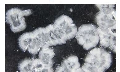
大きい単一の結晶がまばらに析出しより密な結晶を形成
