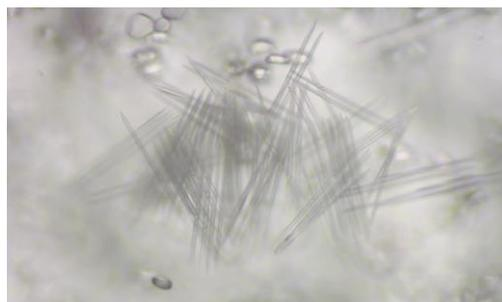
図1  $\text{CaC}_2\text{O}_4$ の針状結晶
