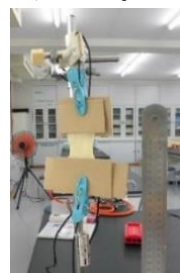
図6 重りを吊り下げた伸びの実験
