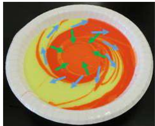
図2 ワイゼンベルク効果が起こる仕組み
