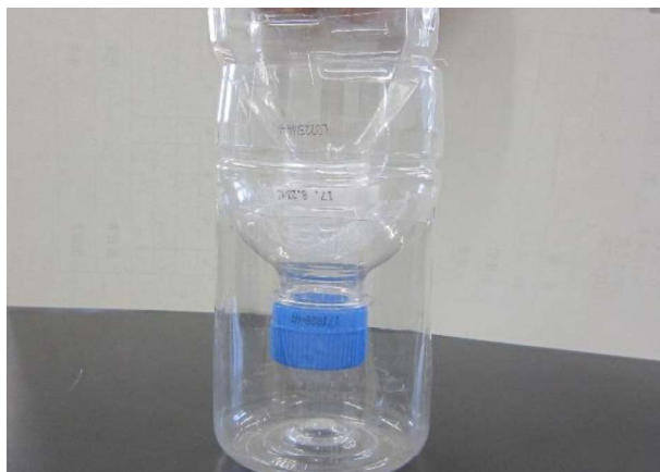
図3 本研究で使用したバールマン装置
