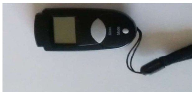
図5 非接触放射温度計
