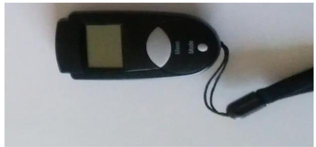
図5 非接触放射温度計
