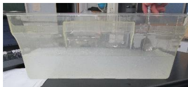
図7 10gの吸水性ポリマーに2700mlの水を加えた様子
