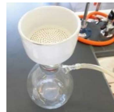
図2 吸引ろ過装置
