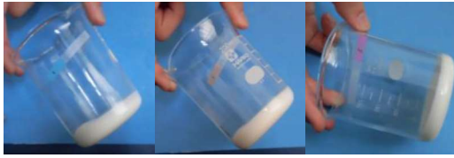
図6 リン酸アンモニウムの増加に伴う 凝固物の変化
