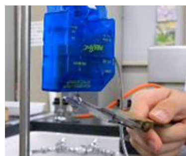
図7 高精度力センサ（島津理化）を用いた力の測定
