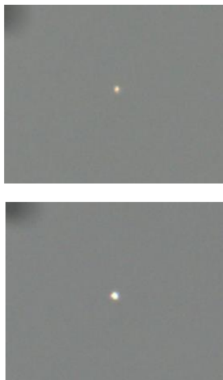
図8 アルタイルの天体画像 上: フードなし 下: 60 cmのフード
