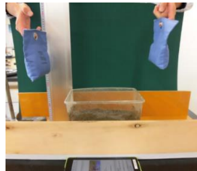
図1：実験1の木板に水槽をのせ、両端におもりを落とした様子
