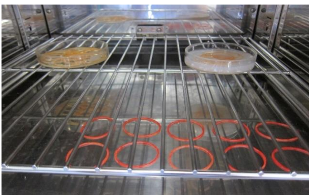
図3 80℃で各操作を施して放置した輪ゴムの様子
