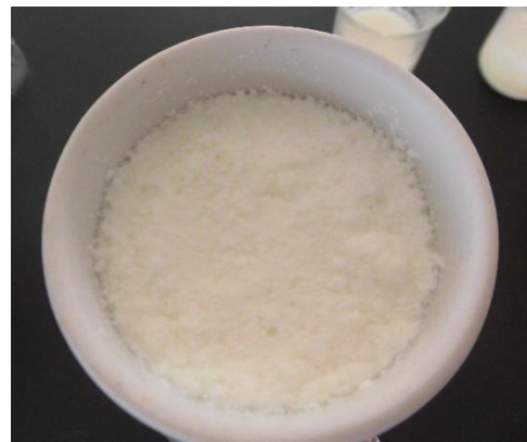
図8 吸引ろ過後の凝固体(レモン汁)
