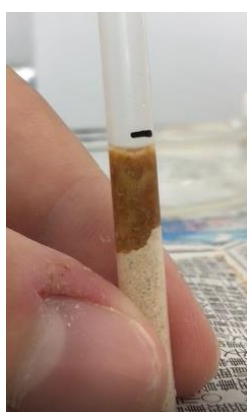
図5 詰めた粉に水が浸み込んだ後
