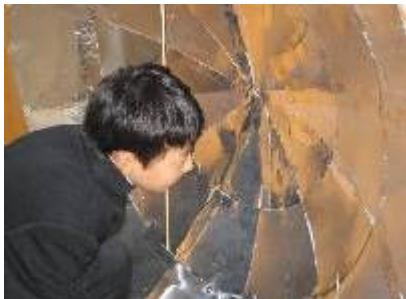
17. 廊下で15～20mほど2台のパラボラを話して音の通信実験を行った。一方のパラボラの焦点付近で小声を出し、もう一方のパラボラの焦点付近に耳を近づけると、はつきりと声が聞くことができた。成功！
