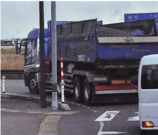
▲碎石を山積みにしたトレーラーダンプ
